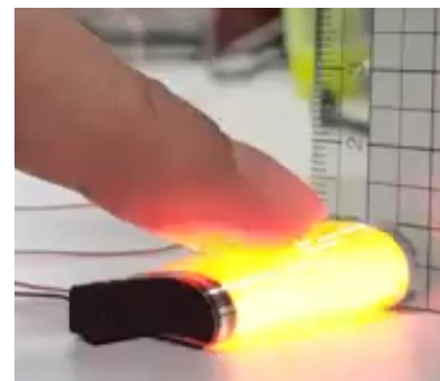
本バリア構造による フレキシブル有機EL R=5mmの湾曲性達成
